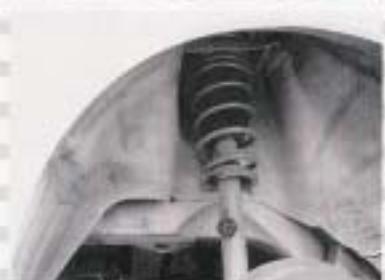
▲プロトタイプ ショックアブソーバー&スプリング 運動性能と乗り心地の両立を目指しセッティング中。車高は-30mmとしました。
